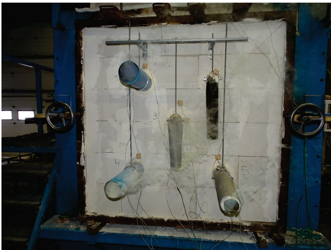
Foto 7 Proefstukken na 30 minuten verhitting
