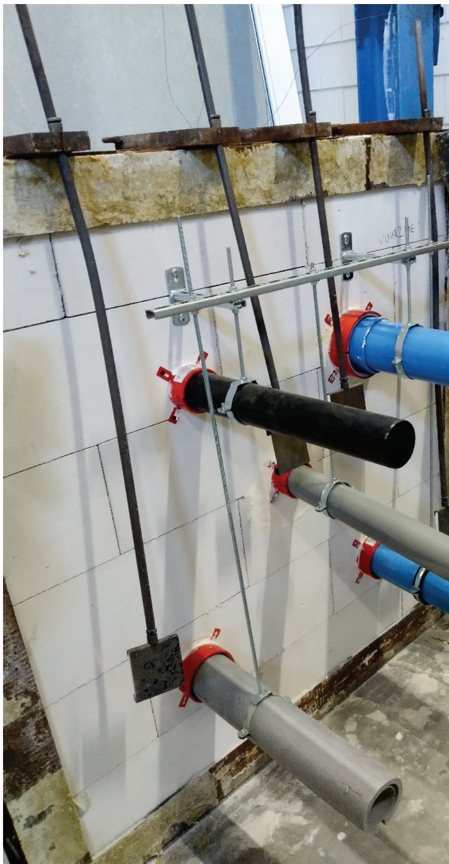
Foto 3 Overzicht van de proefstukken aan de verhitte zijde
