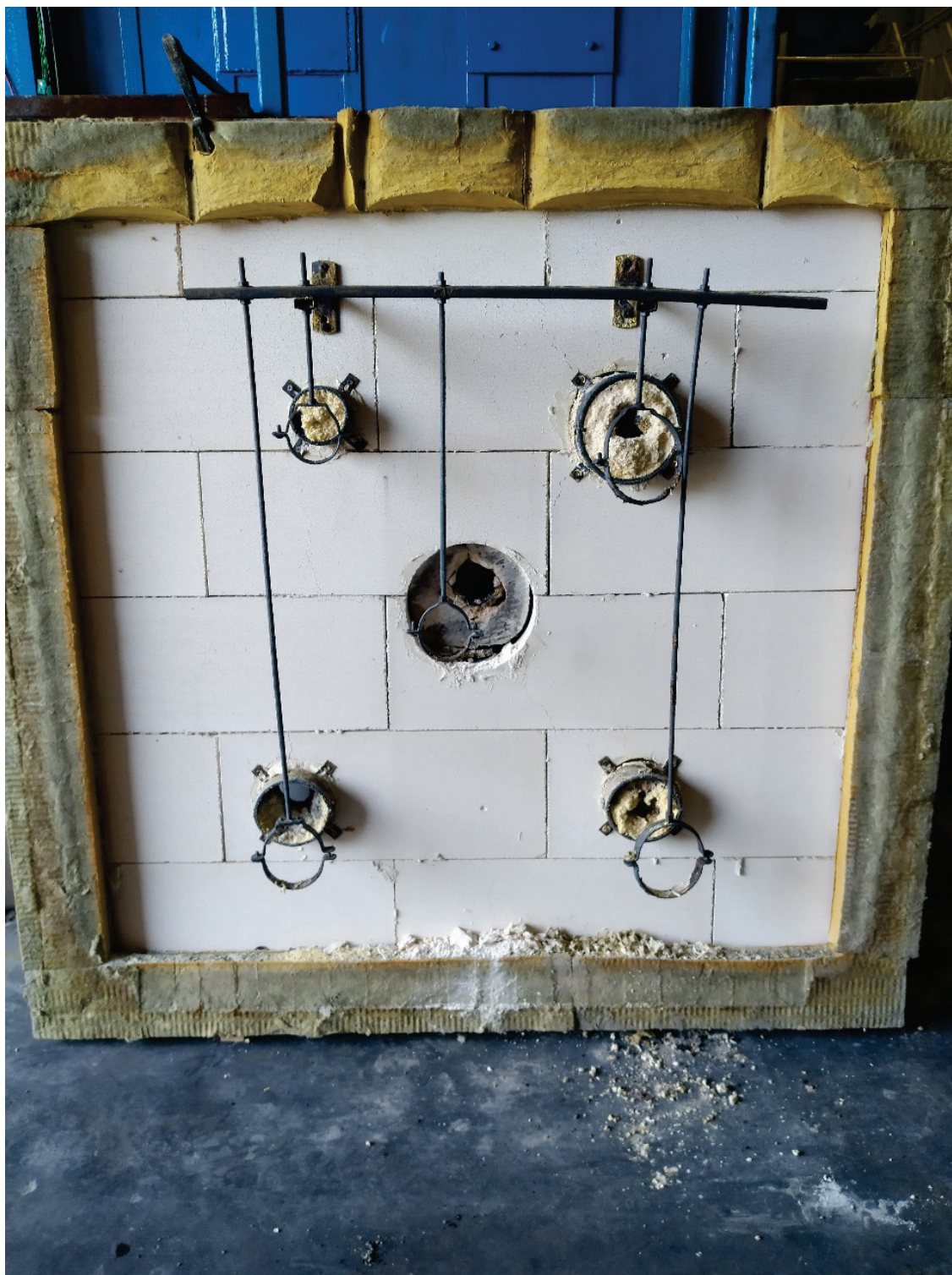
Foto 13 Proefstukken na de test gezien vanaf de verhitte zijde
