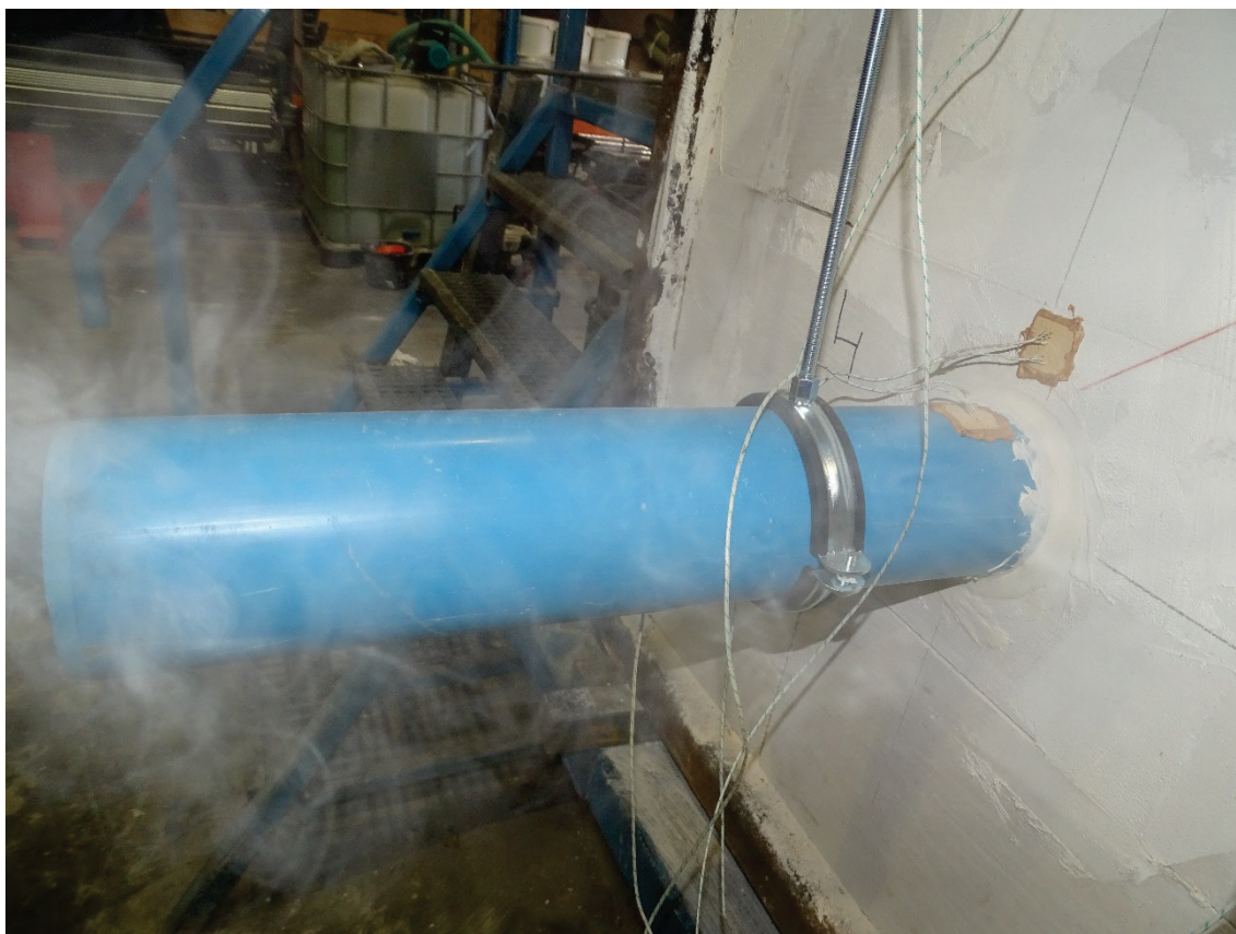
Foto 6 Proefstuk 4 na 16 minuten verhitting
