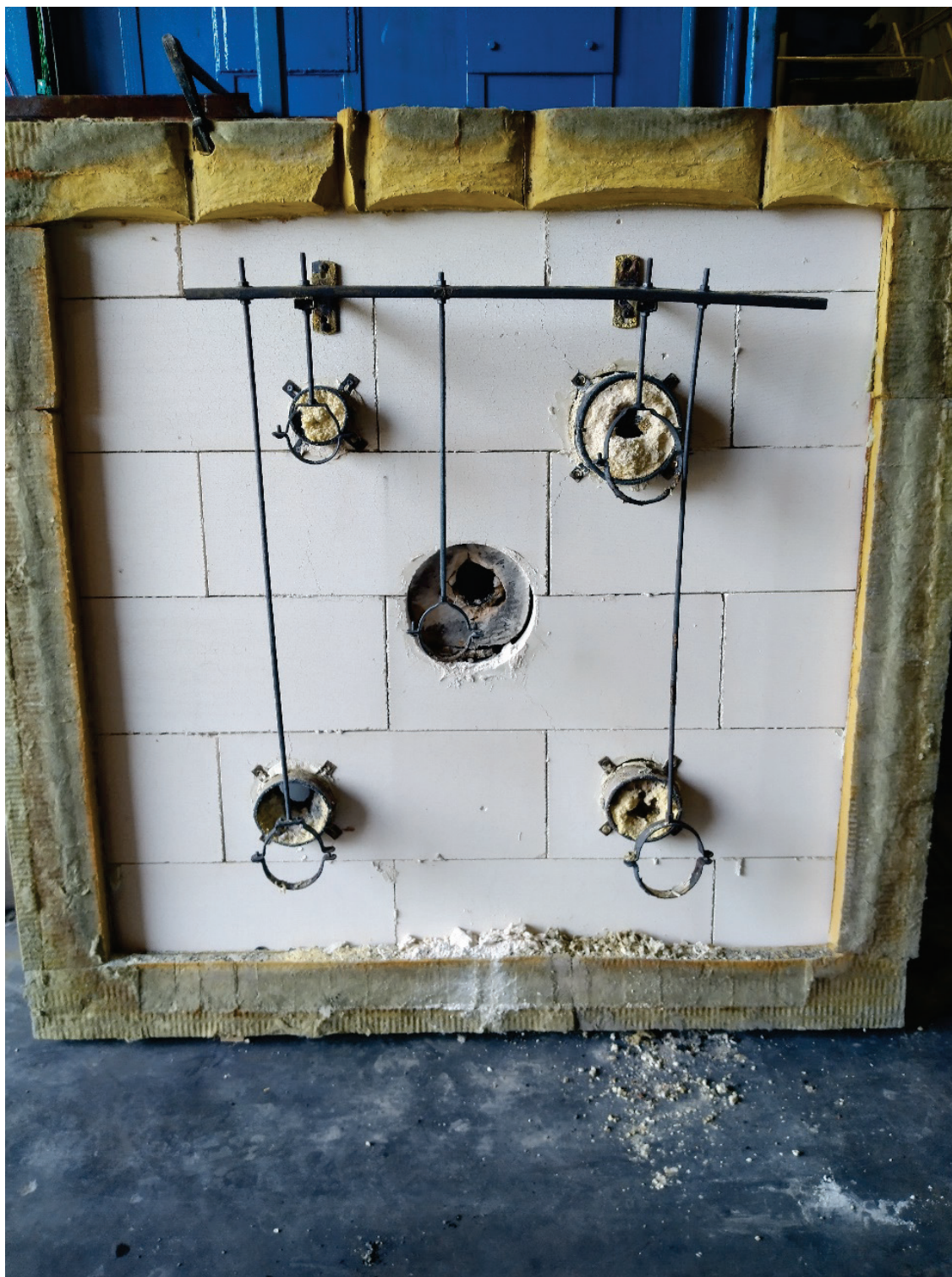
Foto 11 Proefstukken na de test gezien vanaf de verhitte zijde
