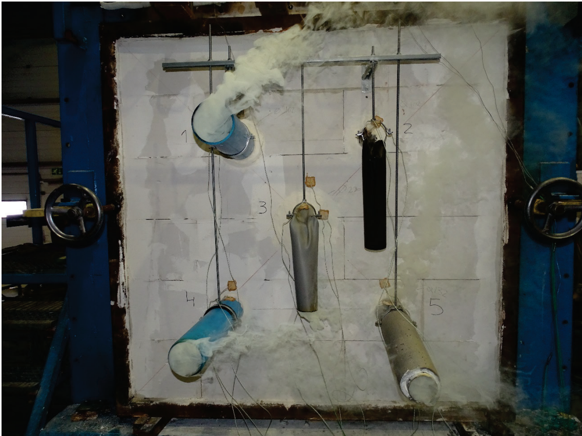
Foto 7 Proefstukken na 45 minuten verhitting
