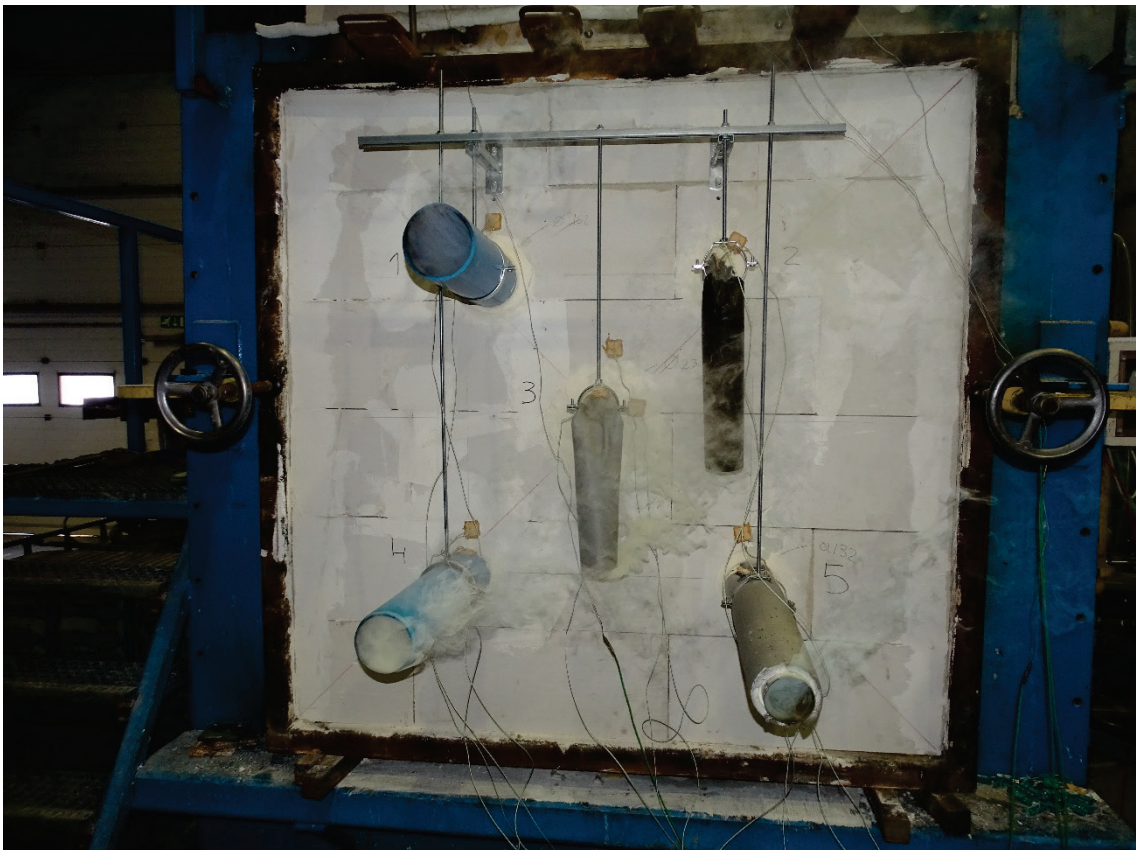
Foto 6 Proefstukken na 30 minuten verhitting
