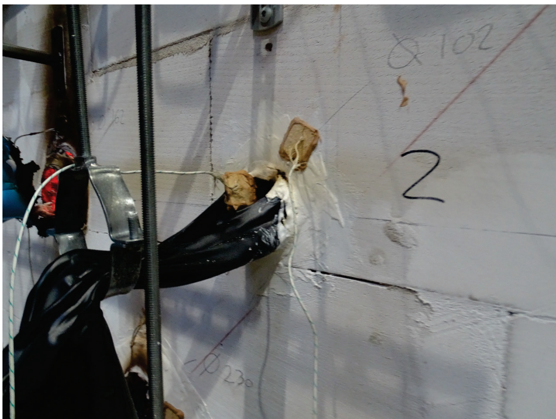
Foto 10 Proefstuk 2 na 135 minuten verhitting
