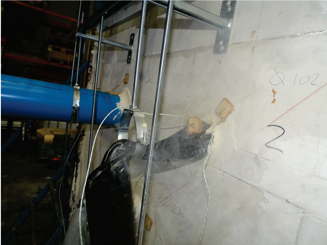
Foto 5 Proefstuk 2 na 16 minuten verhitting
