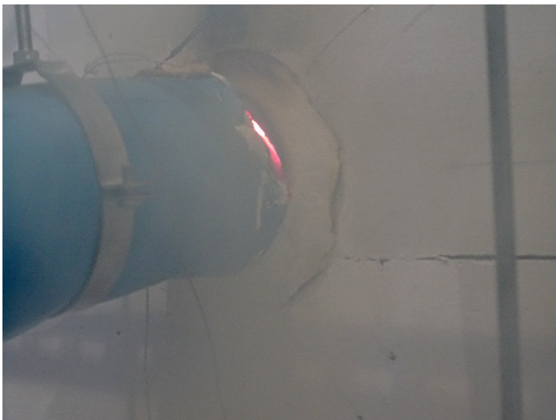
Foto 12 Proefstuk 1 na 94 minuten verhitting
